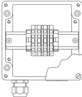
Схема электрических соединений для корпуса подключения Ex 300
