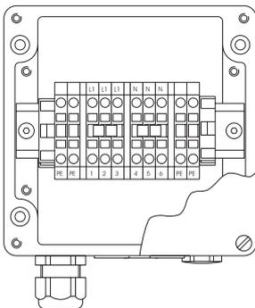
Схема электрических соединений для корпуса подключения Ex 400 S
