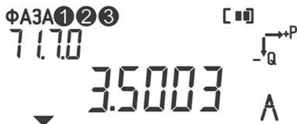
Рисунок Е.6 - Пример индикации текущего значения тока по фазе С
